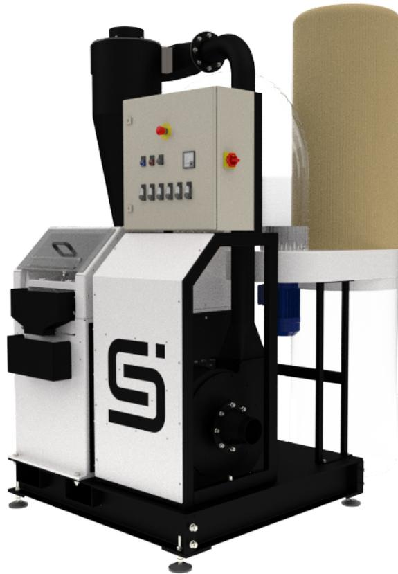
**DE** Der Trenntisch DSP.11 ist eine Podestvariante, die für die Metallrückgewinnung aus Kabelmahlgut konzipiert ist. Durch einen Unterluftventilator wird ein Fließbett auf der Sieboberfläche erzeugt, das zusammen mit der Siebneigung die Leichtfraktion von der Schwerfraktion trennt. Beide Faktoren können stufenlos eingestellt werden, um die beste Trennleistung zu erreichen. Der Trenntisch ist flexibel und kann für verschiedene Anwendungen eingesetzt werden.
