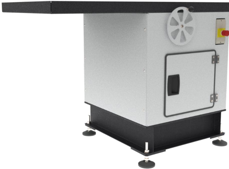
**DE** Die Vermahlstation VMS.120 ist optimal für die Vermahlung, Zerkleinerung und Homogenisierung von Monolithbruch aus dem Katalysatorenrecycling geeignet. Ähnlich wie bei der VMS.100, kann die VMS.120 aufgrund der Verarbeitungskapazität (200 kg/h) für die Vorbereitung von Probenahmen und Analytik verwendet werden. Die Absauganlage P.120 sorgt für einen verlustfreien Prozess und sammelt das Material staubdicht nach entsprechender Reinigung.
